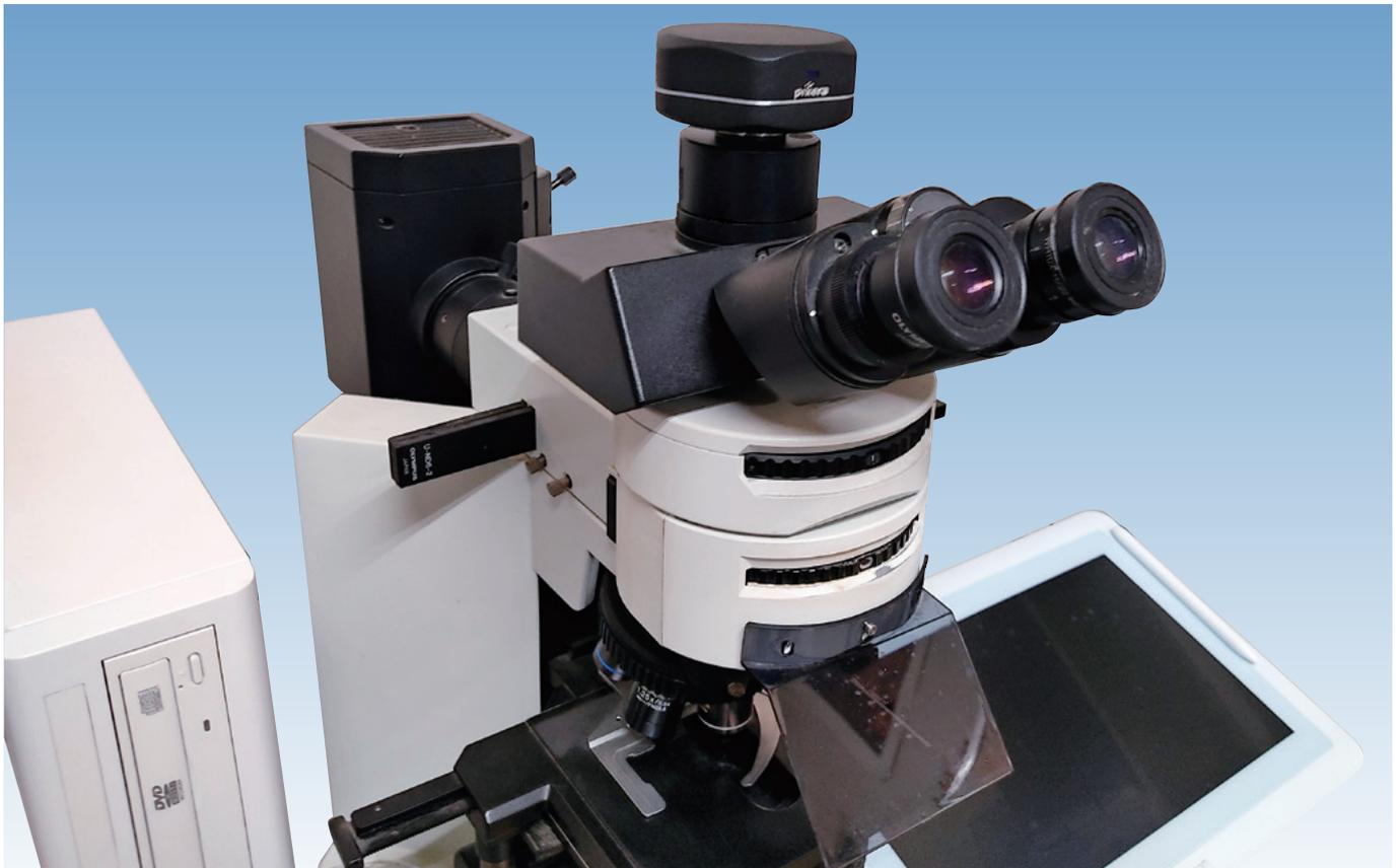
顕微鏡に接続したデジタルカメラより取り込まれた画像をディスプレイに表示して、それを見ながら計測できますので、ディスカッションしながらの計測が出来ます。
